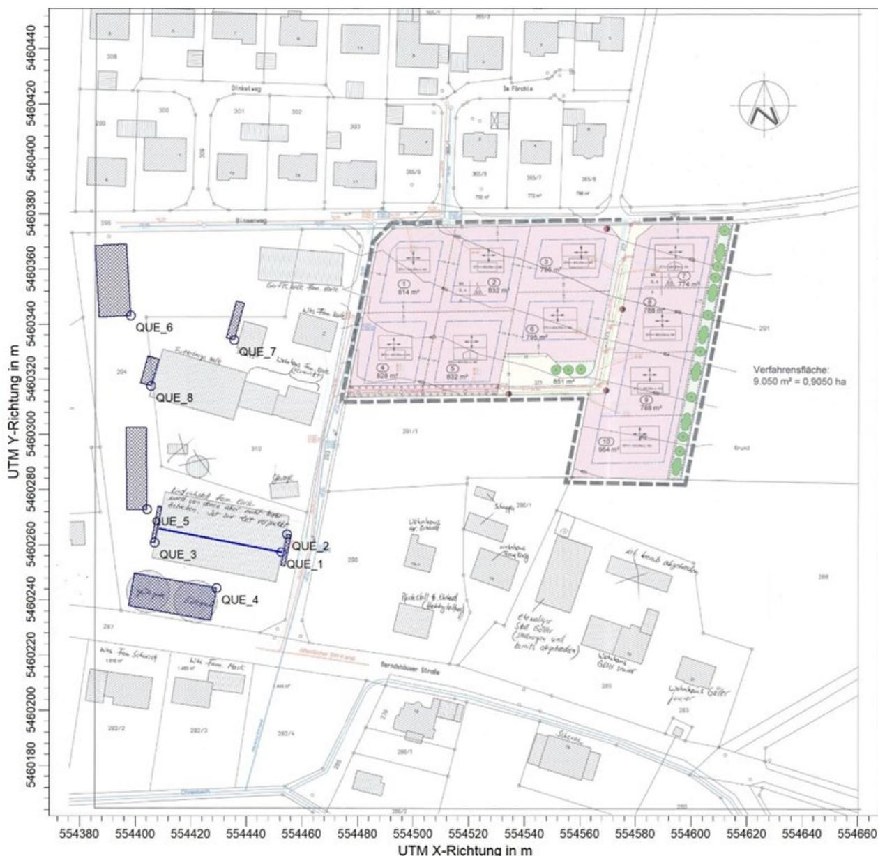
Abbildung 3-4: Emissionsquellen (schraffiert, Linie) im Modell
